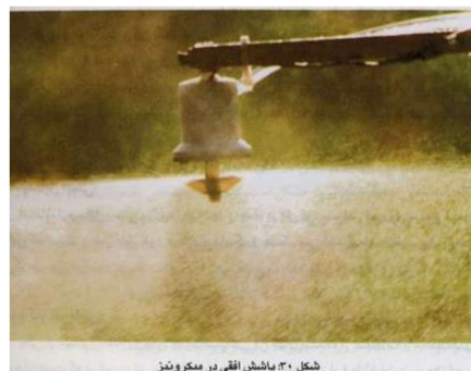
شکل ۳۰: پاشش افقی در میکرونیز
