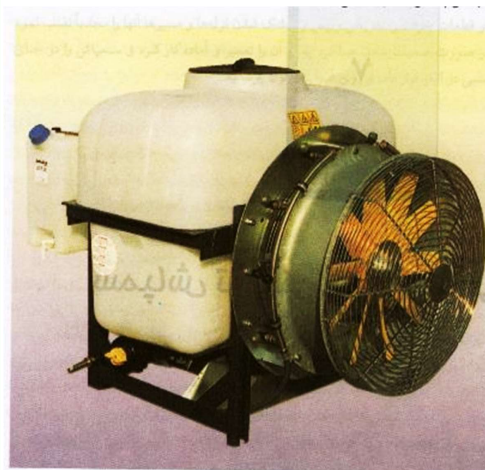
شکل ۲۶: شمایی از سمپاش توربینی اتومایزر باغی
