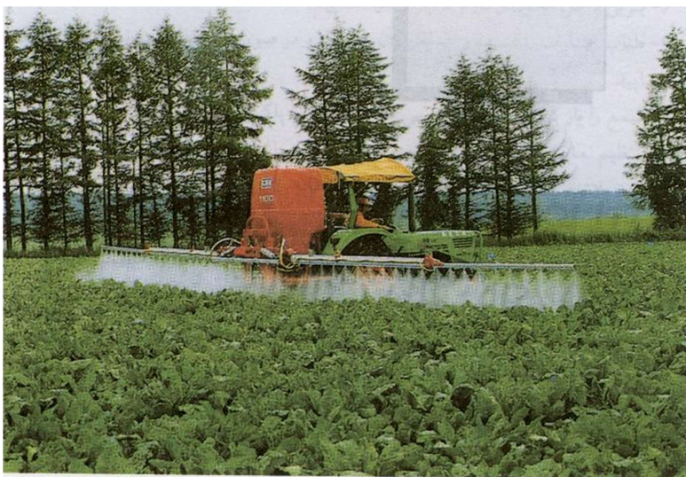
شکل ۲۰: نمای عمومی سمپاش ۴۰۰ لیتری پشت تراکتوری بومدار
