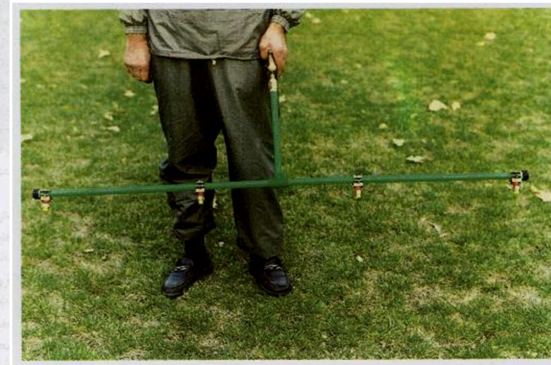
شکل ۶: بوم دستی ۲ مخری مجهز به نازل‌های تی جت جهت پاشش بکثافت محلول سمی
