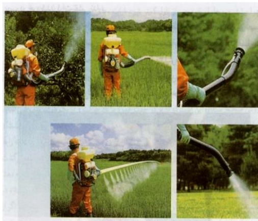
شکل ۱۳: شیوه‌های مختلف استفاده از سمپاش پشتی اتومایزر
