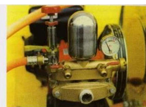
شكل ۱۶: نمونه موتوری پستی مجهز به موتور بنزینی، فشارسنج، مخزن فشار و پمپ لانس
